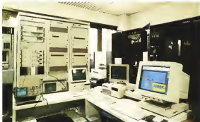
La sala di controllo del sistema motore. A sinistra i collegamenti via satellite, e dietro i moduli della base via cavo.
